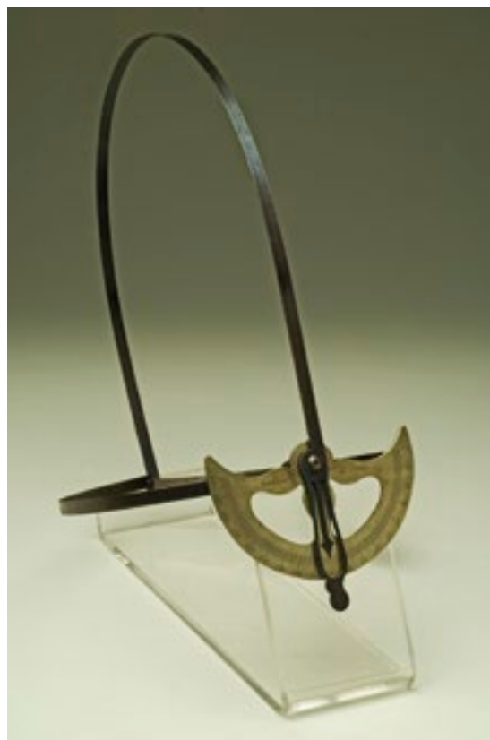
Fig. 17 Goniometro facciale mediano di Broca. Si compone di due pezzi: una molla rettilinea e un indicatore che dà la direzione della linea facciale. La misura dell’angolo facciale è leggibile sul quadrante anteriore di ottone (Collezione Strumenti scientifici, cat. 39).
