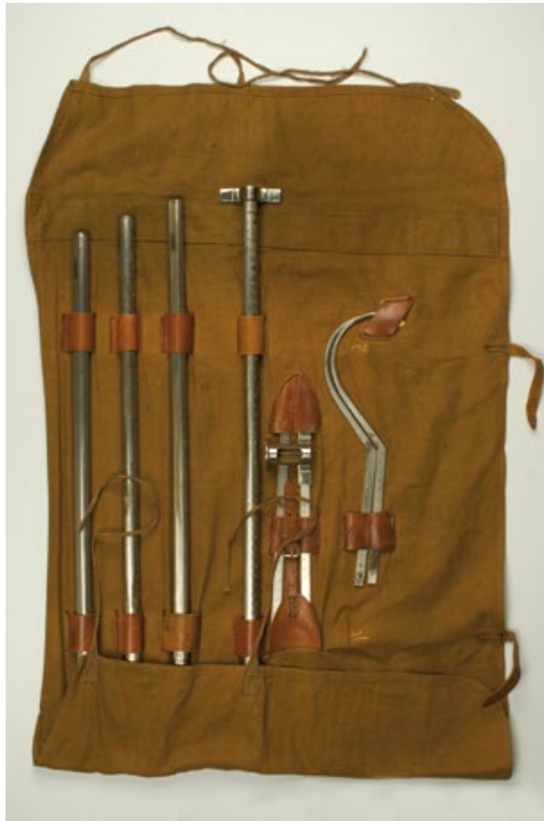
Fig. 16 Antropometro da campagna per la rilevazione delle misure sul vivente. L’astuccio di tela contiene uno strumento per la misurazione della statura e un compasso millimetrato per effettuare misure della testa (Collezione Strumenti scientifici, cat. 17).
